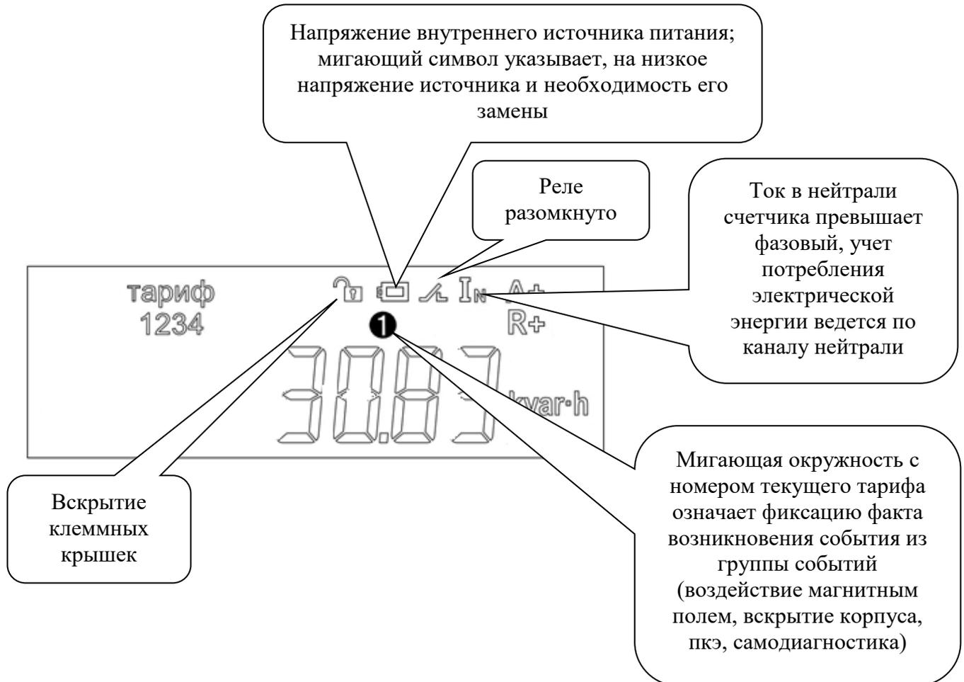
Рисунок Д.1.2 - Пример отображения символов событий для счетчика внутренней установки в корпусе 7мТН35, 9мТН35)
