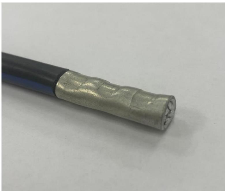
Рисунок 16 - Пример обжатия многожильного провода
