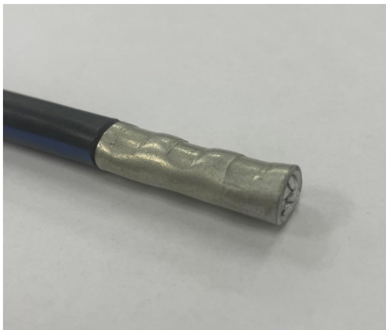
Рисунок 14 - Пример обжатия многожильного провода
