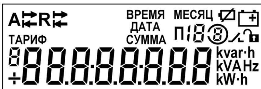
Рисунок 9 - Общий вид ЖКИ блока индикации счетчика в корпусе SPLIT
